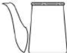
5 Saldobrasatura collo di cigno Goose-neck braze-welding
